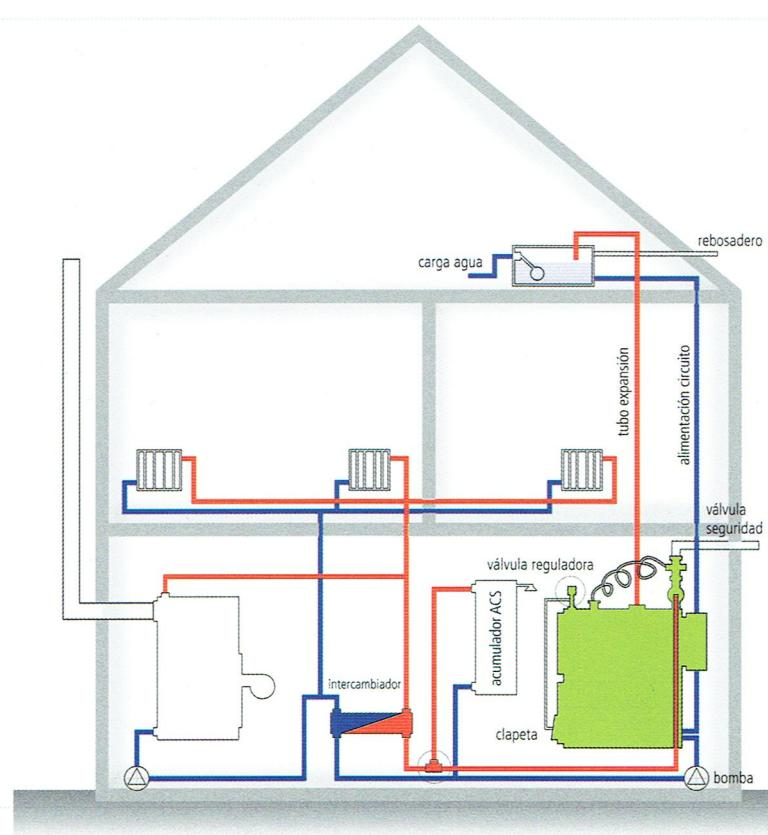
Esquema de instalación de una caldera de leña "MADEIRA" conectada en paralelo con una caldera de gasoil para calefacción y ACS.
