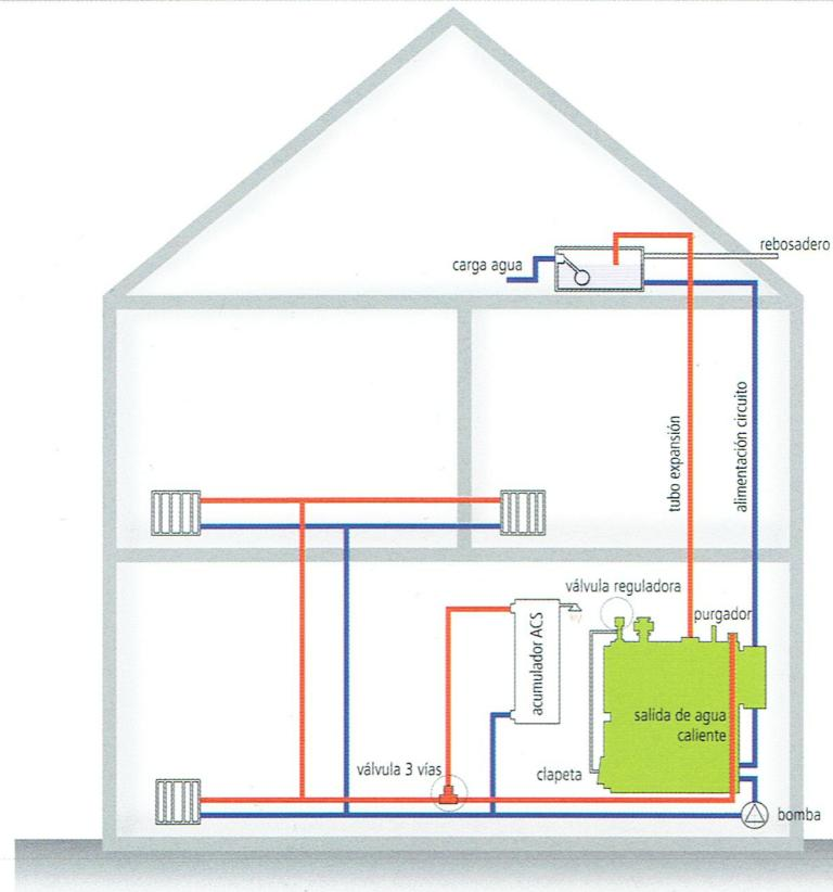
Esquema de instalación de una caldera de leña "MADEIRA" para calefacción y ACS.
