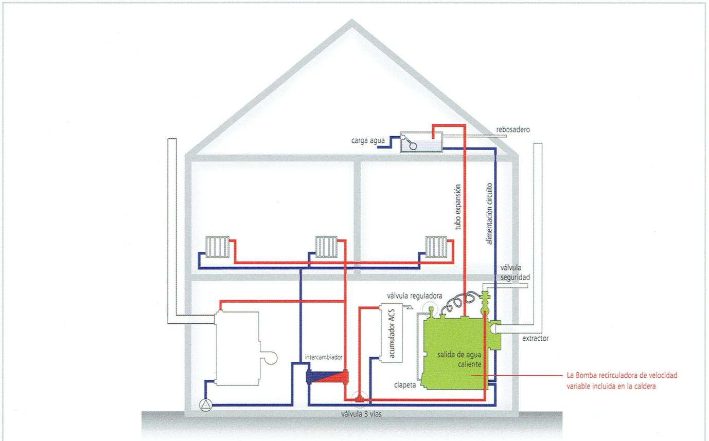
Esquema de instalación de una caldera de leña "FORTALEZA" conectada en paralelo con una caldera de gasoil para calefacción y ACS.
