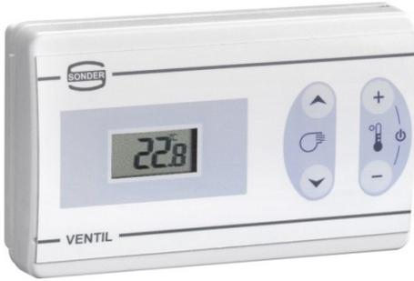
El VENTIL 1D es un control electrónico para unidades de Fan-Coil, capaz de regular la temperatura ambiente o remota, con una escala de 5 a 30°C. Para ello dispone de sensor interno y una entrada de sonda remota (Accesorio opcional para regular la temperatura de la sala de forma remota).
