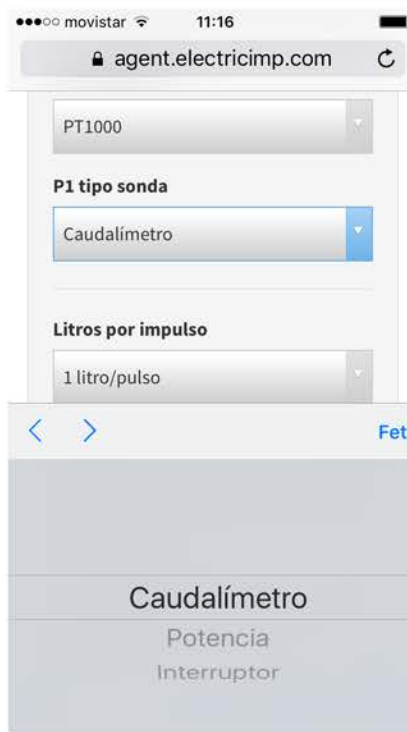
Paso 24: Ejemplo de selección de uso del interruptor P1 como caudalímetro o contador de potencia o como interruptor (cierre o apertura de contactos, por. ejemplo una ventana, puerta, etc.
