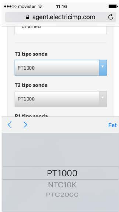
Paso 23: Ejemplo de selección tipo de sonda entre PT1000, NTC10K y PTC2000, operar de igual modo en T1 y T2. Aceptar
