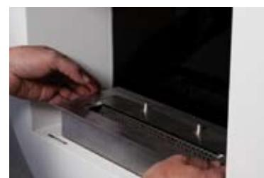
Placer le(s) brûleur(s) dans l'insert ou l'encadrement prévu à cet effet.
