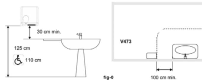
**Funcionamiento:** Colocar las manos debajo del aparato. La secadora se activa automáticamente, permaneciendo en funcionamiento mientras las manos se encuentren dentro del campo del sensor. El aparato se apaga después de unos segundos de retirarlas.
